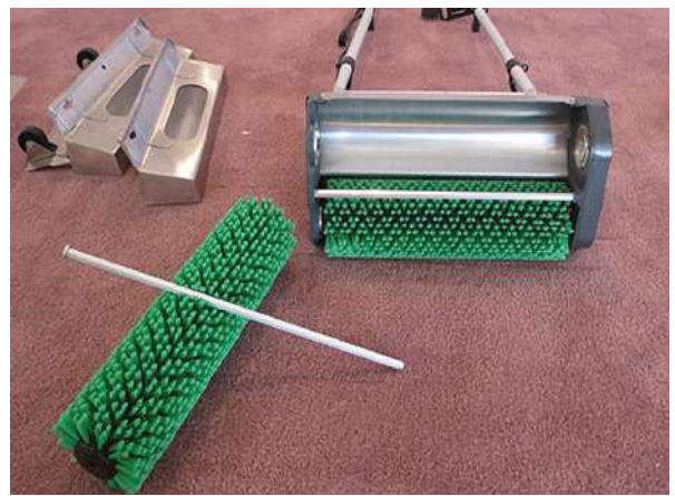
19 Align Bar & Brush and Push until it slides all the Through – DO NOT FORCE Alinee la barra y el cepillo y empuje hasta que se deslice completamente- NO FUERCE
