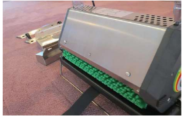
17 Removing Receptacles – Push Button and slide Left Extracción de receptáculos: presione el botón y deslícelo hacia la izquierda
